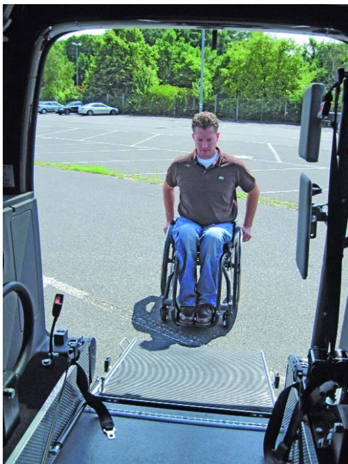
Der VW Caddy mit Heckeinstieg. Das Gurtsystem sowie Rücken- und Kopfstütze dienen der Sicherheit des Passagiers.
