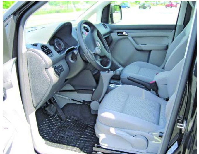
Der VW Caddy hier mit Umrüstung für Selbstfahrer (Handbedienung Bremse/Gas, Lenkraddrehknopf).
