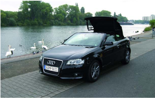
Das Akustikverdeck des AUDI A3 Cabriolet kann auch im Fahrbetrieb bis 30 km/h geöffnet und geschlossen werden.
